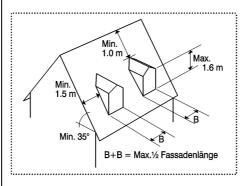
Dachaufbau mit Darstellung der Fronthöhe beim Satteldach
